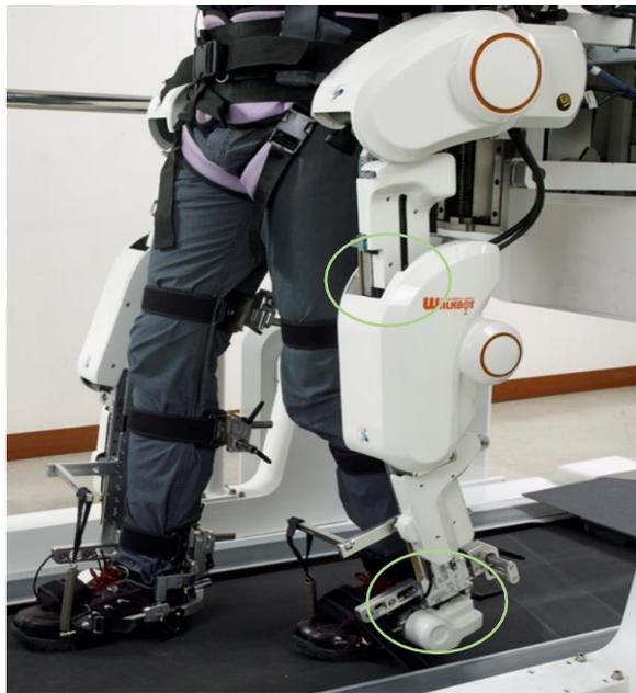
Рис.2. Роботизированные ортезы для ходьбы Walkbot
